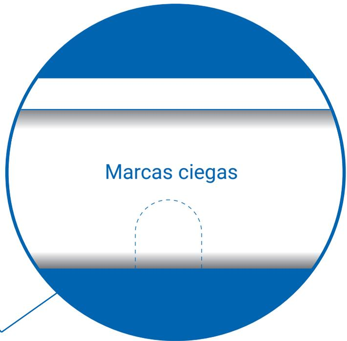
**La tapa trasera posee marcas ciegas, el instalador podrá utilizar la que crea mas conveniente perforando la misma.**
